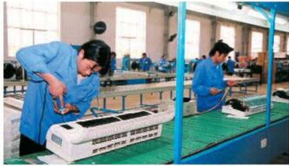
d) Lắp ráp máy điều hoà nhiệt độ
